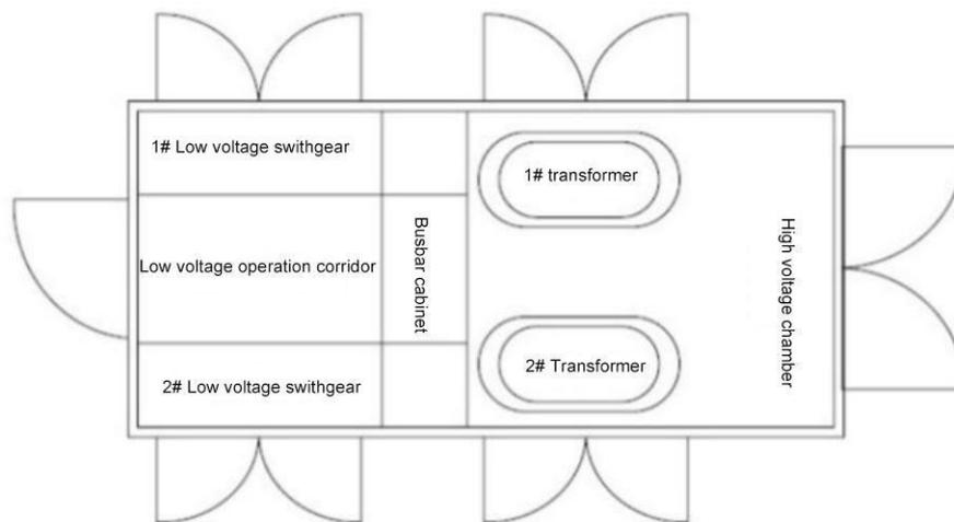
“目”字型结构两台变压器
